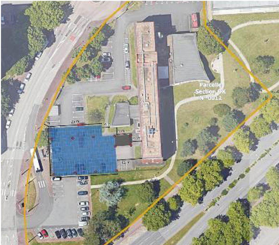
La puissance générale de l'installation est de 143kWc. En complément du projet photovoltaïque, deux bornes de recharge seront installées sur le même parking, de manière à préparer la transition de la flotte de véhicules du SDIS 87 vers l'électrique.
