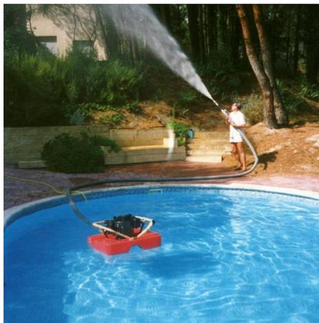
*Autoprotection au moyen d'une motopompe flottante*
